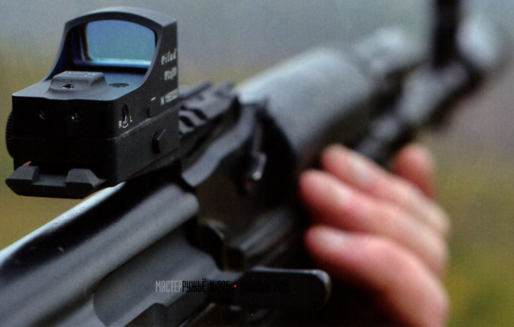
Легкосплавный кронштейн «Кочевник-2» с прицелом Р1х20
